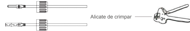
▲ Figura 5.14 Encaixe do pino de contato no fio
