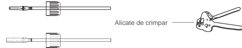
▲ Figura 5.14 Encaixe do pino de contato no fio
