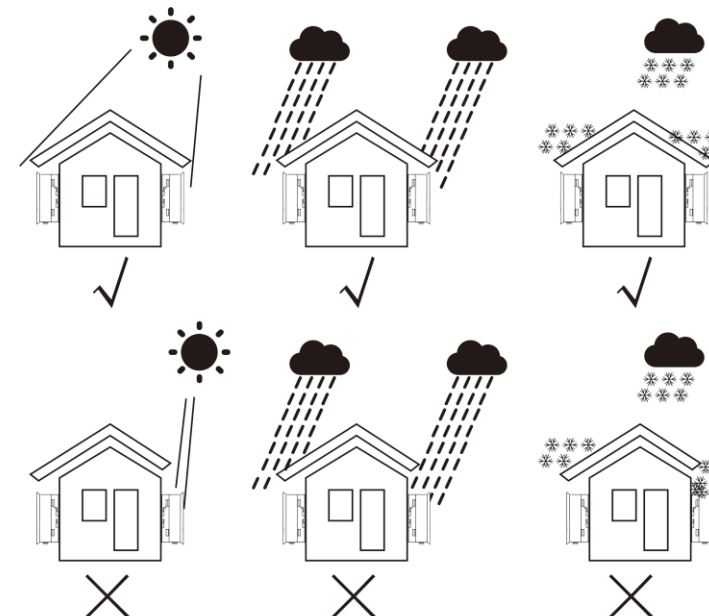
▲ Figura 5.1 Posição de instalação recomendada
