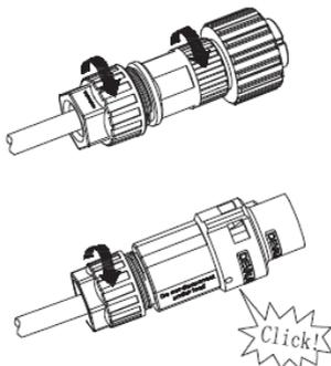
4. Por fim, empurre ou parafuse a luva rosçada no terminal de conexão até que ambas estejam firmemente travadas no inversor.
