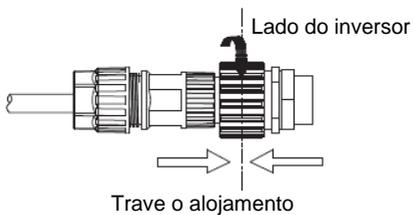
5. Para remover o conector CA, pressione a baioneta para fora do encaixe com uma pequena chave de fenda e puxe-a para fora ou desaparafuse a luva rosca e puxe-a para fora.
