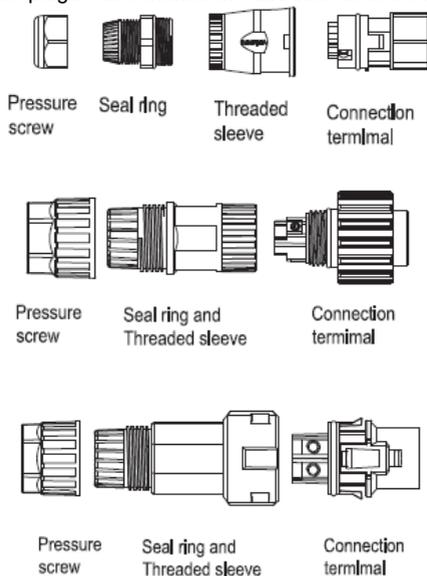
2. Insira o cabo desencapado e exposto através da rosca de pressão, anel de vedação, manga roscada em sequência, insira os cabos no terminal de conexão de acordo com as polaridades indicadas e aperte firmemente os parafusos. Tente puxar o fio para garantir que ele está bem conectado.
