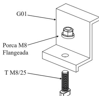
ANTES DE INICIAR A MONTAGEM RECOMENDA-SE MONTAR OS GRAMPOS DE FIXAÇÃO COM SUAS RESPECTIVAS MOLAS, PARAFUSOS E PORCAS
